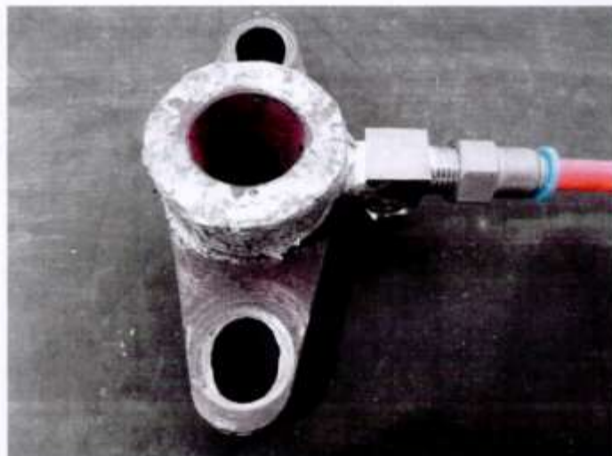
填料压盖 Gland flange
